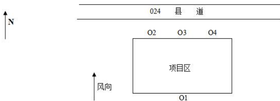
图 7-1 无组织废气监测布点示意图
