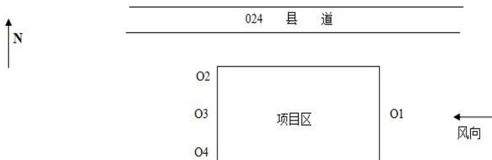
图 7-1 无组织废气监测布点示意图
