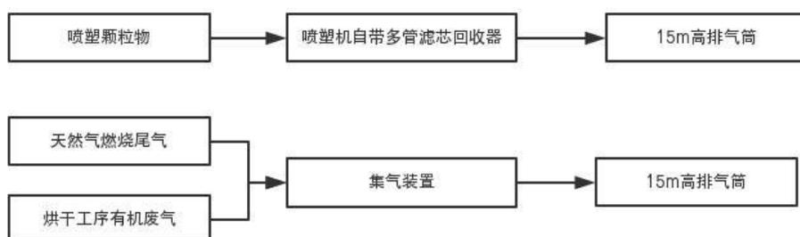
图 4 废气产生及处置工序图
