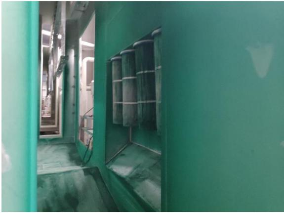
喷塑工序多管滤芯回收器
